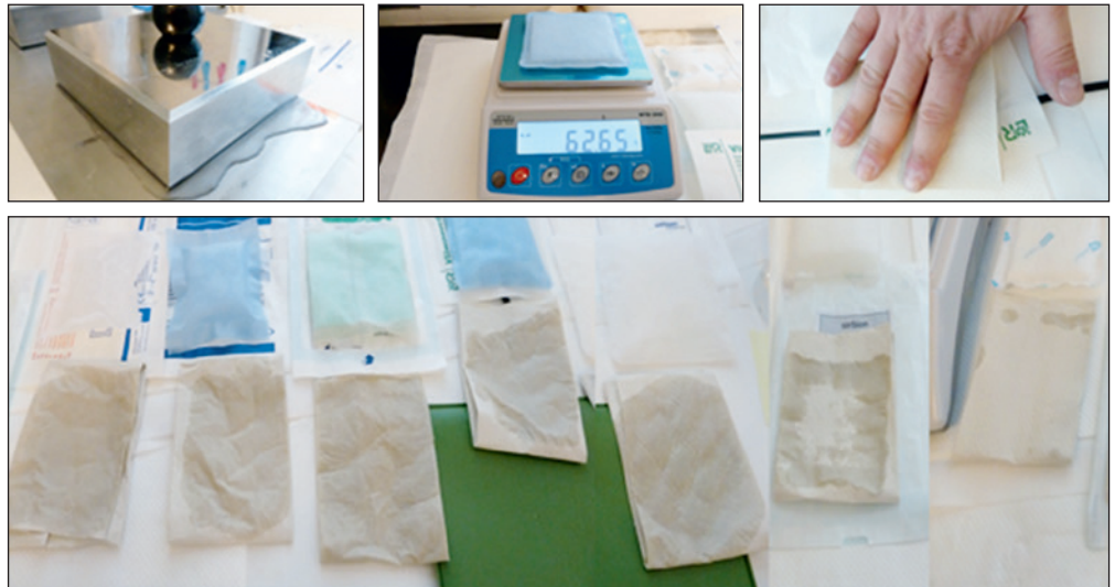
Verschiedenen Produkte nach kompletter Sättigung – die auf die Rückseite aufgelagten Papierhandtücher erscheinen nach 30 Sekunden Auflagezeit bei fast allen Produkten als nass.
